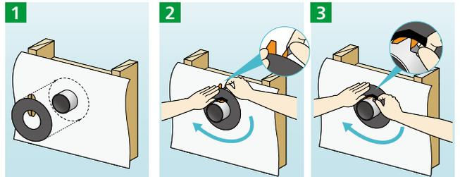
製品を配管(ダクト)を通し、防水紙表面まで押し込みます。製品を防水紙に押しつけた状態で、外側セパレーターをはがします。(はがした後は防水紙へ圧着) 立ち上げ面をしっかりと密着させ、内側セパレーターをはがせば完成です。(ダクトにしっかり貼りついていることを確認)
